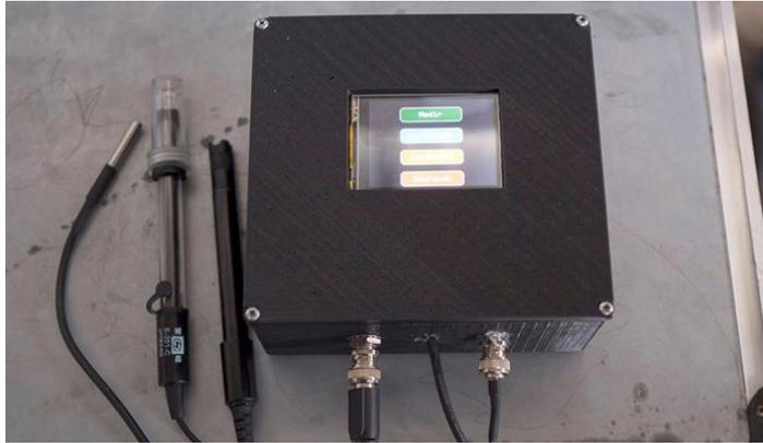
Figura 13: Equipo de medición de parámetros para piscinas camaroneras finalizado.
